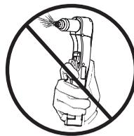
При резке необходимо следить за тем, чтобы искры вылетали снизу заготовки.
